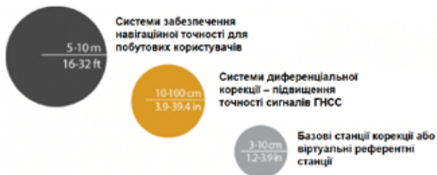
Рис. 3. Рівні точності позиціонування залежно від приймача та поправок, що їм використовуються
