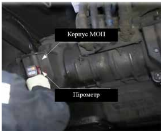
Рис. 2. Процес вимірювання температури МОП за допомогою пірометра
