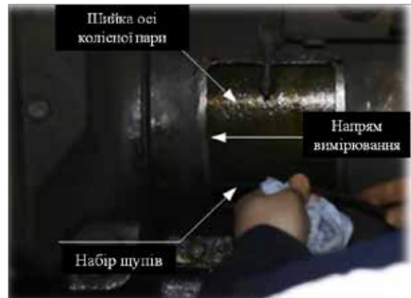
Рис. 3. Процес вимірювання «зазору на мастило» МОП
