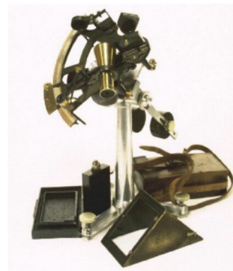
Рис. 8. Ртутний штучний горизонт
