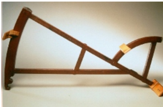
Рис. 5. Зовнішній вигляд квадранта Девіса
