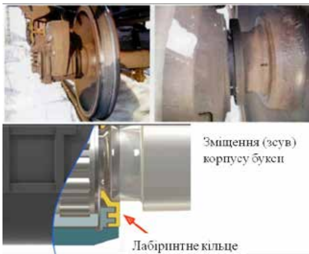
Рис. 7. Ознаки несправності буксового вузла
